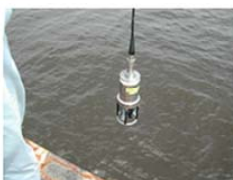
調査状況(多項目水質計)
